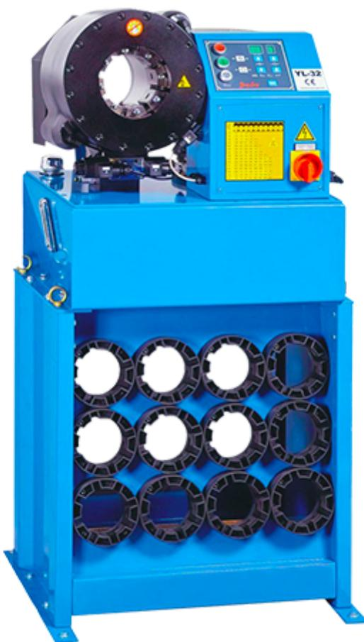
Пресс YL32S - электрический станок стационарного исполнения применяется при мелкосерийном производстве и ремонте Рукава высокого давления РВД шлангов РВД высокого давления в сервисных мастерских, на предприятиях по ремонту оборудования.
